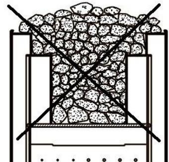
Размещение камней, поперечное сечение отсека для камней в нагревателе
