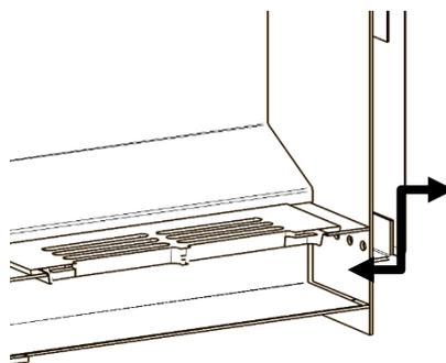
Для оптимальной работы важно после каждого использования очищать зольник нагревателя, чтобы открыть отверстие для воздуха под колосниковой решеткой и обеспечить свободное прохождение воздуха в печь.
